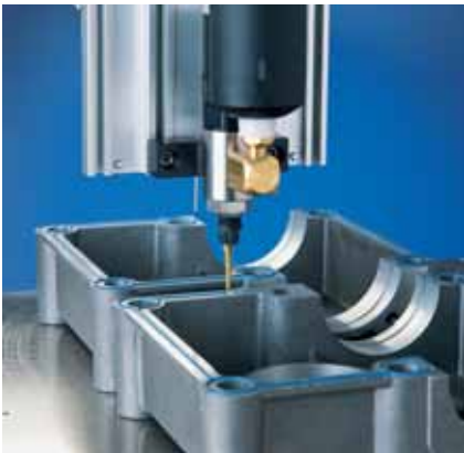
Los sistemas Ultra 325TT y 525TT son totalmente tridimensionales, capaces de trazar líneas y arcos en diferentes planos, así como también aplicar puntos y llenar cavidades.
